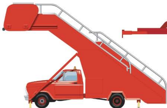
escalier M automateur mobile passenger stairs escalerilla F transportable bewegliche Fluggasttreppe F scaletta F semovente
